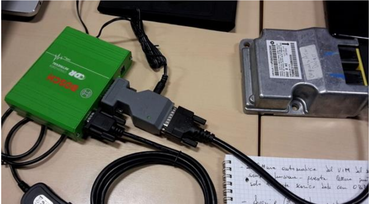
(Dispositivo CDR Bosch connesso all'ACM)
